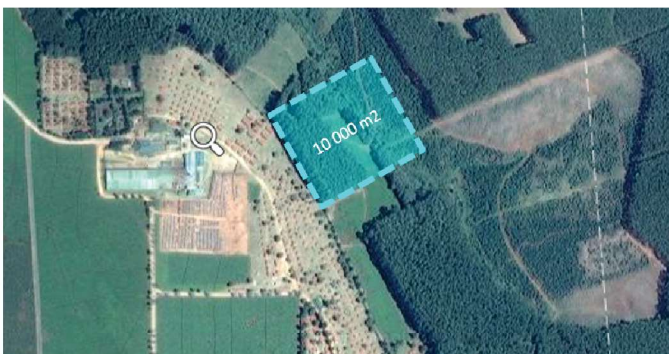
Teplantagerna eldar meterved av eukalyptus för att torka tebladen. En installation on 10 000 m 2 solfångare skulle täcka 50% av energibehovet och ersätta 100 hektar plantageskog.
